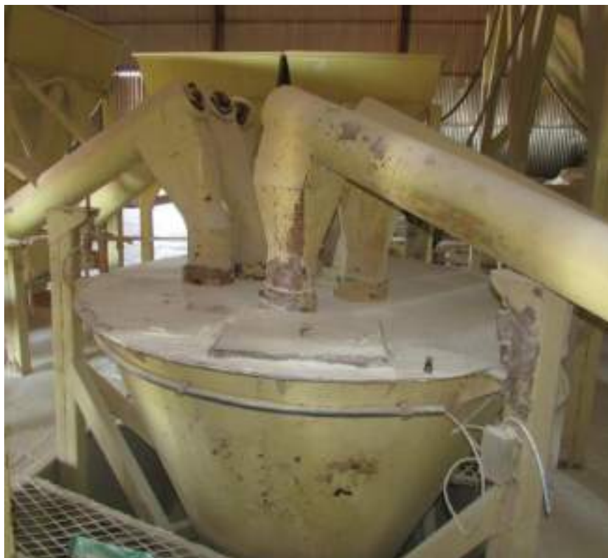
Figura 2 – Misturador horizontal para sal mineral e ração.
