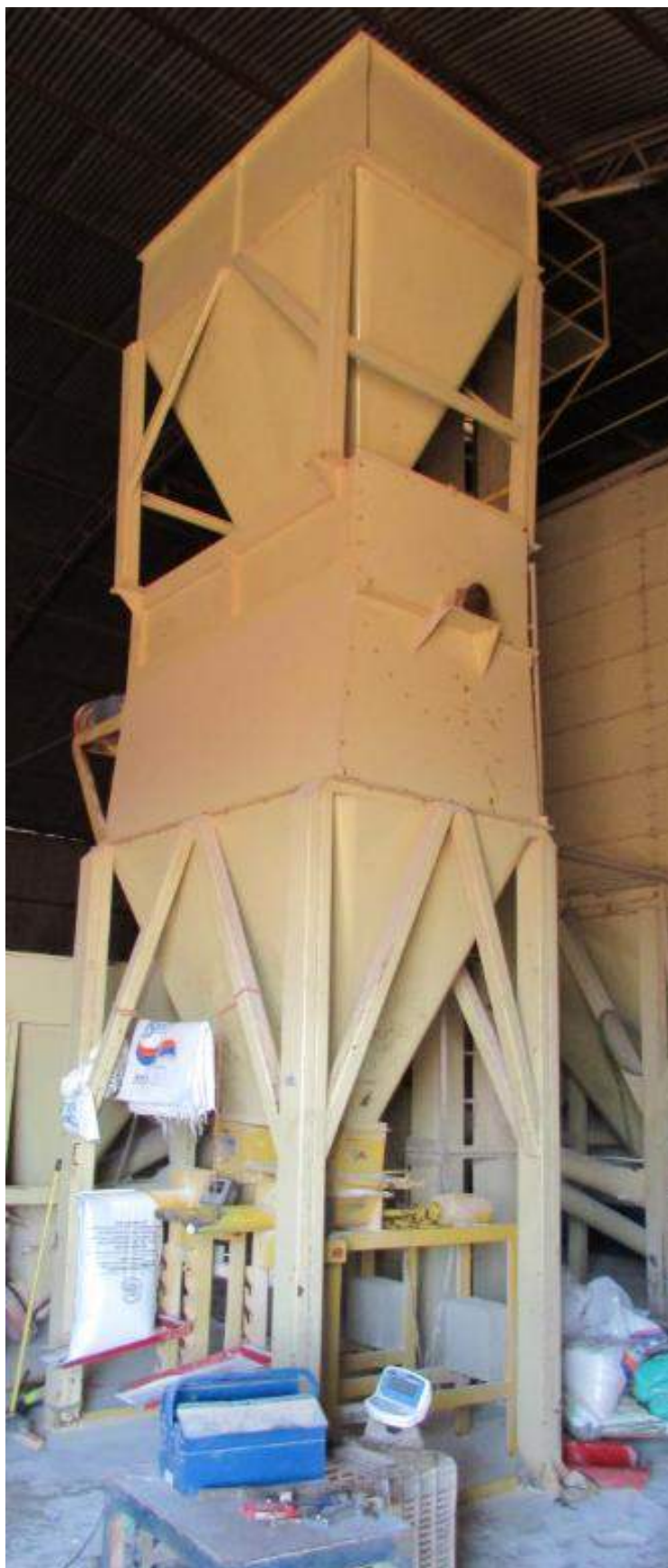
Figura 5 – Caçamba dosadora com balança eletrônica e elevador de caneca ao fundo.
