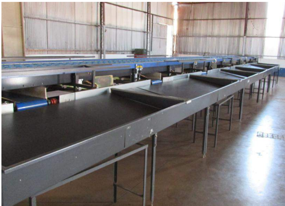
Figura 6 – Máquina classificadora de frutas, Classificador de frutas 4 l 11 s
